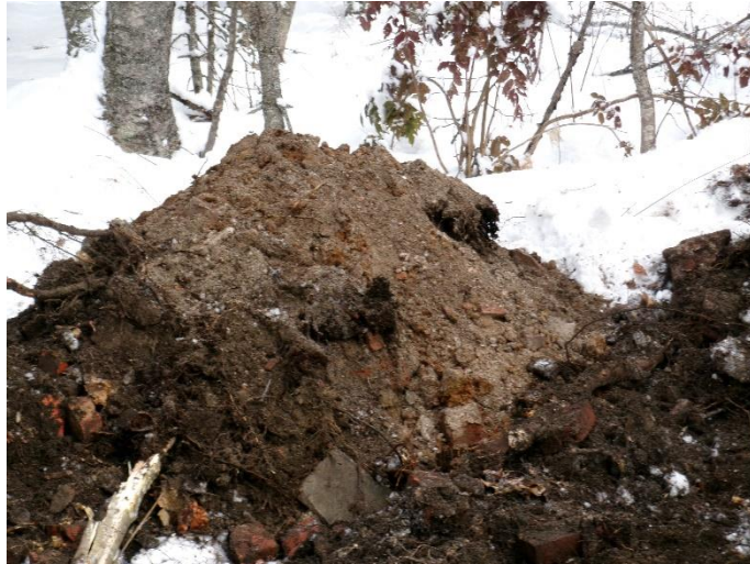
TP-2 spoils pile 0-2.5'
